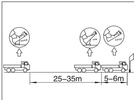
要顺利使车辆停止,应按下述步骤操作制动踏板。
