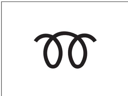
按下预热开关, 预热指示灯亮, 预热塞加热; 松开开关, 指示灯熄灭。预热开关的使用每次不得超过 40 秒。
