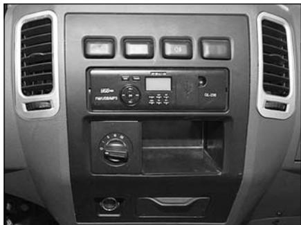
空气经制热装置后由暖风机内部各风门分配到除霜、主副驾驶迎面、吹脚等风口来进行除霜及调节车身内温度的目的。
