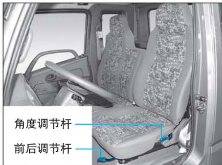
1. 将座椅前后调节杆自右向左旋转,直至调节器解锁,然后,调整前后至舒适位置,松开调节杆,锁定调节器。
