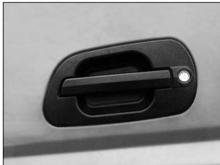
将钥匙插入锁孔内，车身左车门顺时针旋转，右车门逆时针旋转，车门门锁被打开，反之则门锁锁上；门锁打开后向外拉动车门把手即可打开车门。
