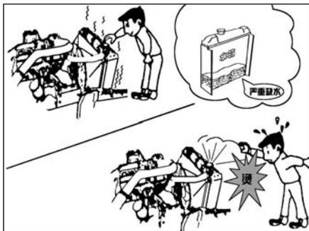
发动机过热有可能是因为冷却水不足而过热，在检查时应注意不可以立即取下水箱盖，以防烫伤。
