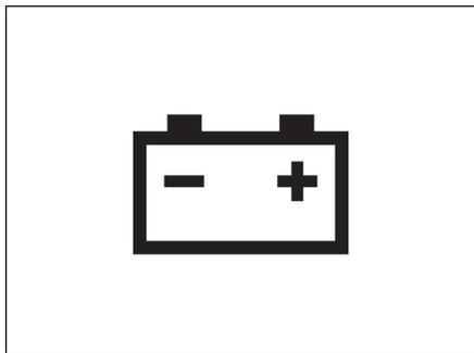
当钥匙开关处在 ON 的位置时, 该指示灯亮。发动机启动后发电机给蓄电池进行充电时, 该灯熄灭。如果行驶过程中充电系统发生故障停止充电时, 该灯就点亮。
