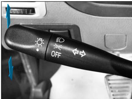
夜间会车时,一定要使用变光开关。打开前大灯后将复合开关操纵杆上下来回运动,实现近光与远光的转变。
