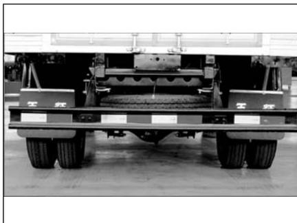
根据法规要求，车辆安装有侧面及后下部防护装置。
