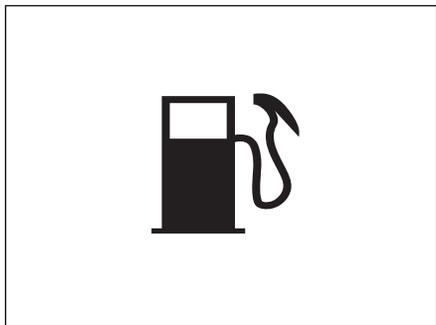
当燃油箱内的油位降到所规定的下限油位以下时,燃油指示灯点亮报警。
