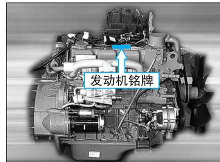
发动机编号标刻在气缸体的侧面或上平面。
