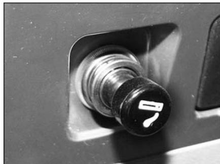
按下点烟器按钮,待电阻丝红热后,按钮自动弹出,此时拔出按钮即可使用。
