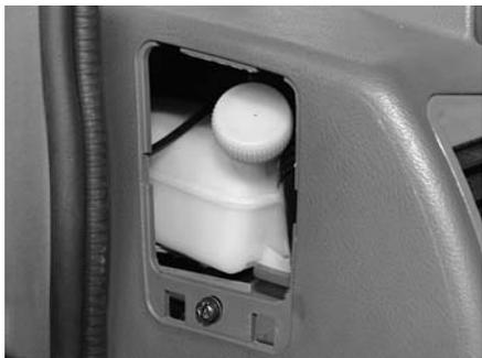
当制动液的液面过低报警灯亮起时，检查油杯总成内的制动液液面是否在杯体上“MAX”(上限)和“MIN”(下限)之间。如果低于下限应添加制动液，否则检查制动器是否磨损或是电路是否有问题。
