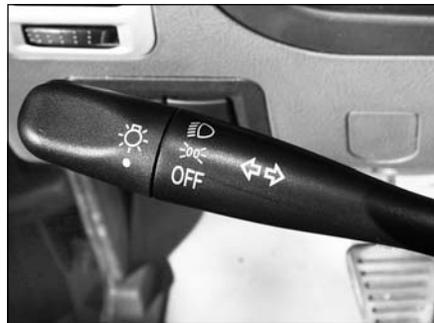
当小灯及近光灯打开时,可通过交替抬起和松开复合开关,实现远光的瞬时亮起和常亮。其它灯光均关闭时,操纵杆抬起,超车灯就点亮,松开操纵杆,超车灯熄灭。
