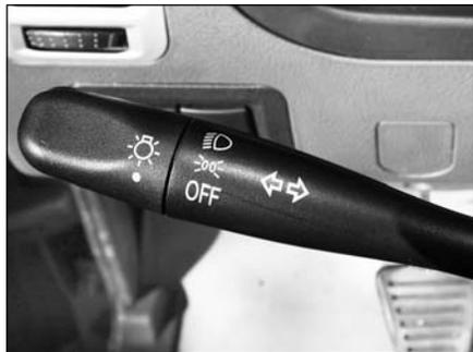
组合开关手柄是由车灯控制开关、转向信号灯开关、大灯变光开关、超车灯开关所组成。
