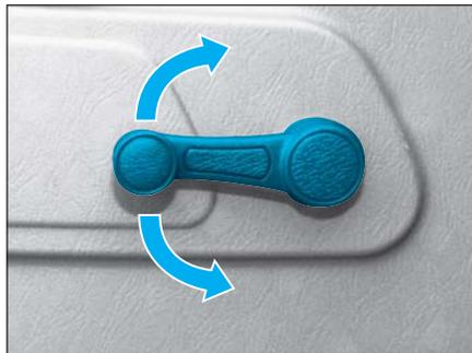
左车门:将手柄逆时针摇转,车门玻璃升起,反之车门玻璃降下。
