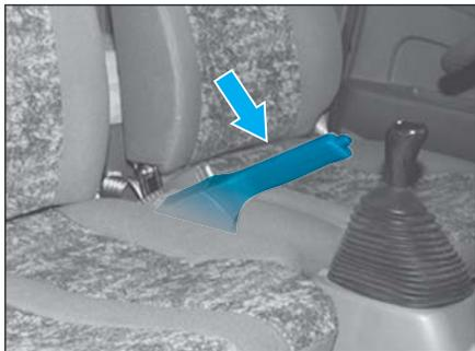
使用驻车制动时，必须充分地拉起驾驶员右侧的驻车制动手柄。要解除驻车制动时，先轻轻向上拉，然后按下按钮将手柄推到底。
