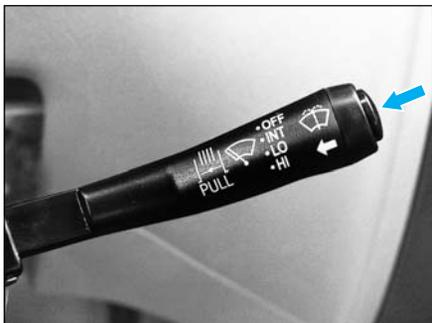
按下开关顶端的按钮,即可使洗涤液喷向风窗玻璃,同时刮水器工作两个循环后自动停止。
