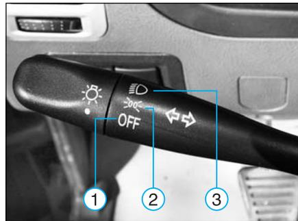
车灯控制开关(手柄顶部)分三档旋转,可以分别点亮下述灯光:
