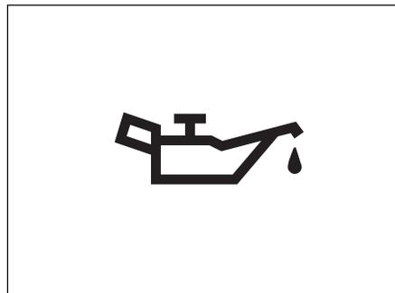
钥匙开关旋至 ON 位置，该灯亮。当发动机启动后，该灯熄灭。在发动机运转过程中，当机油压力异常下降时，该灯就点亮报警。
