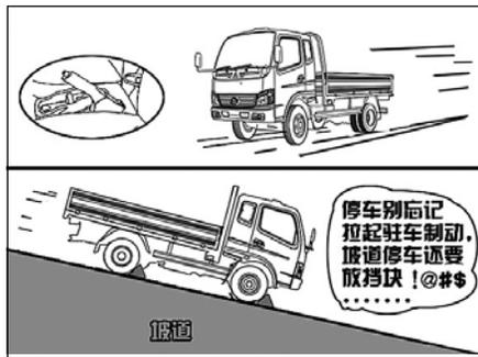
停车就应使用驻车制动。不出车应切断电源。在坡道停车,离开驾驶室时,车轮前应放挡块,以防溜车事故发生。
