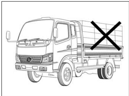
磨合里程为 2500km。新车的磨合情况,对汽车的寿命、工作的可靠性和经济性有很大影响。接到新车后或大修后,尤其是发动机必须严格按照要求进行磨合,然后再投入使用。
