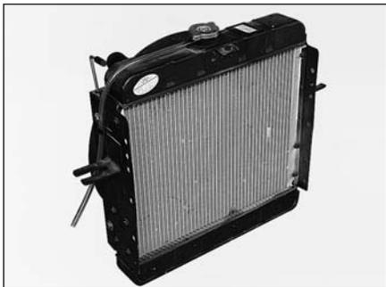
添加冷却液时,上水室应留出 20~30mm 的空间,以利于冷却液膨胀。如果低于此数值要求,则应添加冷却液。
