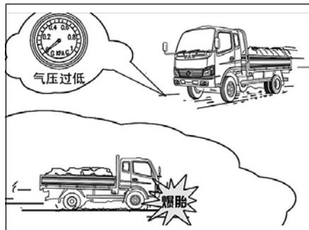
经常检查轮胎气压，轮胎气压不足或过高会缩短轮胎的使用寿命，严重时甚至引发交通事故。
