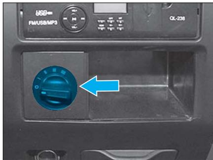
鼓风机风机旋钮可调节风量大小。旋钮从0挡顺时针旋转 I、II、III、IV 挡风凉依次增大。
