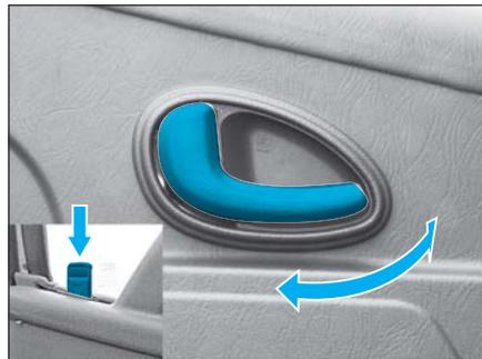
将锁钮按下，车门锁上。反之则打开。再扳动内开把手，即可开车门。
