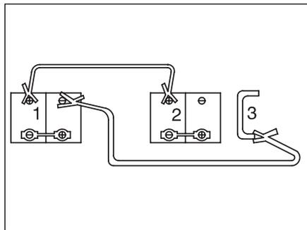
1. 有电蓄电池 2. 无电蓄电池 3. 车架
