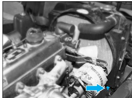
先打开散热器盖(发动机刚停止运转时,不可打开散热器盖,待机体冷却后再打开),然后打开散热器放水开关,将冷却液放出。
