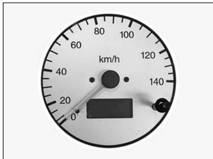
车速里程表包括车速表(单位为 km/h)和里程表(单位为 km)。车速表的指针指示车辆行驶速度。总里程表显示您的车辆已运行的总里程数, 别忘记按里程保养您的车辆。短距离里程表便于您记录某次行驶的距离。将复位按钮按下, 显示的数值可回到零。
