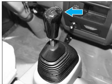
换挡时，一定要彻底踩下离合踏板，在前进挡与倒退挡互换时，一定要使汽车完全停止后进行。当换挡杆拨到“R”(倒挡)位置时，倒车灯亮，语音倒车报警器同时发出警报声。变速器高低挡互相独立，在进行高低挡位转换时必须使用离合器。
