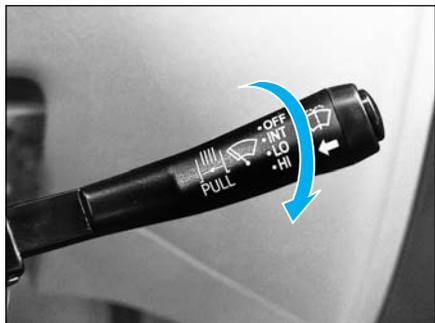
按照图中箭头方向旋转开关,依次为刮水器的关闭(OFF)、间歇档(INT)、低速档(LO)、高速档(HI)。
