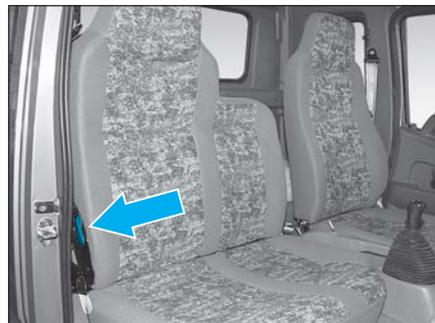
将座椅靠背角度调节拉杆向上拉起,调节靠背至所需的角度的,放松拉杆使靠背锁定。
