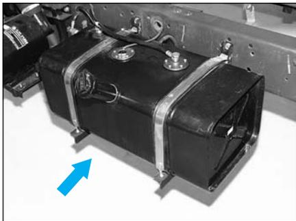
打开盖板，用钥匙打开油箱盖，加入规定标号的清洁燃油。
