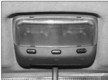
用于车内照明及门灯指示。当您按下顶灯中间开关按钮，顶灯只做门灯指示用途，两个车门任何一扇开启或未完全关闭时，顶灯点亮。当按下两侧任意按钮开关时，同侧对应的顶灯同时点亮，起车内照明灯用途。
