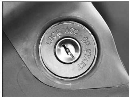
1. LOCK(锁止):钥匙只能在处于 LOCK 的位置上插入和拔出。对于安装电磁电源总开关的车型,钥匙的插入与拔出意味着整车电源的打开或关闭。
